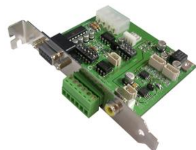
Рисунок 1.4.10 Конвертер RS-232 / RS-485 с аналоговым видеовыходом для 32-канальных плат видеоввода
